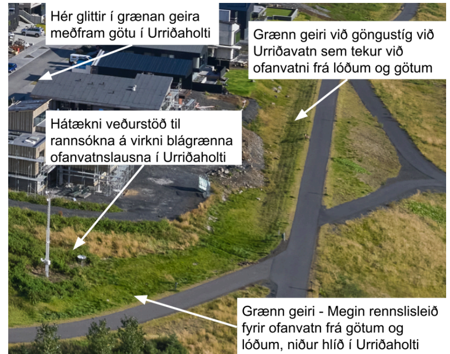
Mynd 5.6 sýnir grænan geira meðfram stíg neðst í hlíð í Urriðaholti sem tekur við ofanvatni af lóðum og svæðinu fyrir ofan. Svipar til þess sem gæti verið nyrst við lóðir á iðnaðarsvæðinu sem liggja við Hjallatún.
