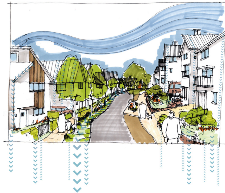
Mynd 4.1. Með blágrænum ofanvatnslausnum er ofanvatn látið sitra niður í jarðveginn næst þeim stað sem það fellur og/eða renna í gegnum byggðina með skipulögðum hætti.
